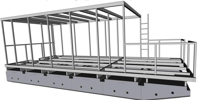
Gesamtauftrieb: 7.620 daN (kg) entsprechend 20 x Schwimmkörper TS\_01 und 4 x TS\_02
